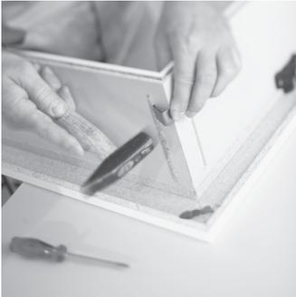
Insérez les clips en acier dans la rainure prévue et frappez les dans la contre-rainure avec un marteau. Essayez l'excédent de colle le plus tôt possible avant qu'il ne soit solidifié.
