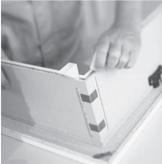
En plus, les coins de protection des revêtements peuvent être enfoncés dans la rainure décorative avec le côté affleurant dans la coupe en onglet. La tension ainsi générée ferme l'onglet.
